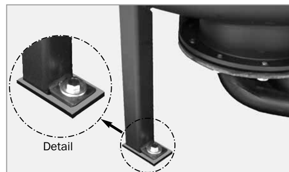
Speicher mit Bodenausgleichsplatten befestigen
